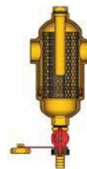
Esquema montaje accesorio: Desfangador + Sep. Magnético
